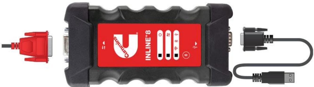
3. Verá que el LED de “Encendido” se enciende fijo en **verde**, el LED de “Computadora” parpadea lentamente en **verde** y el LED de “Vehículo” se apaga, lo que indicará que el adaptador está listo para una conexión de datos.
